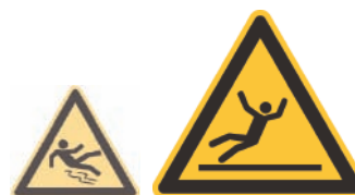
Warnung vor glatter Oberfläche ASR/ISO-W011
